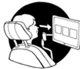
Kommunikationsdator monterad på eldriven rullstol
